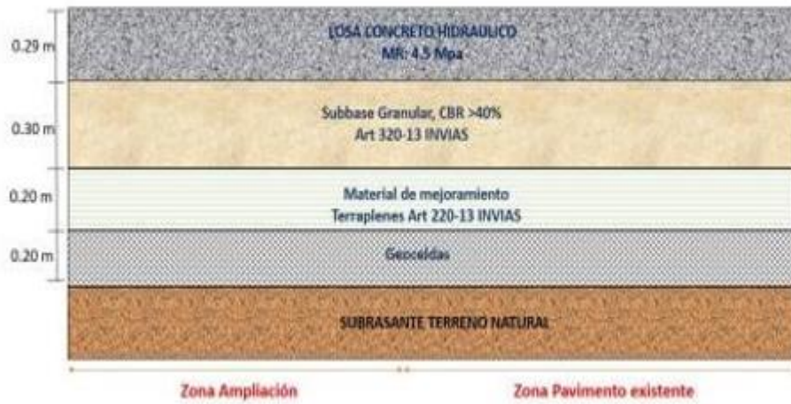
FIGURA 4: DISEÑO DE PAVIMENTO CALZADA IZQUIERDA
