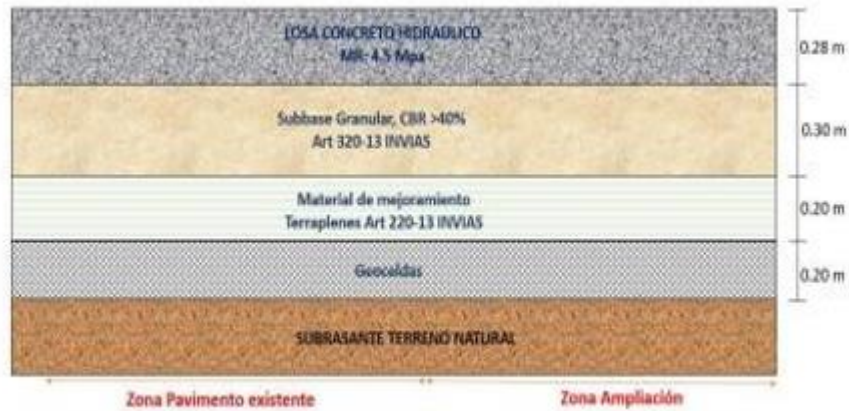
FIGURA 5: DISEÑO DE PAVIMENTO CALZADA DERECHA
