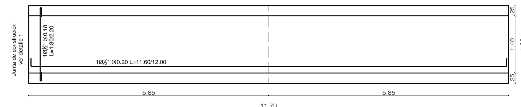
DETALLE REFUERZO SUPERIOR LOSA FONDO BOX 1.40X0.90
